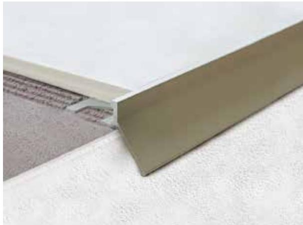
BORDERTEC BBR est le résultat de l'optimisation du Bordertec BBS, conçu pour offrir la même fonction mais avec des dimensions réduites. Il est un profilé pour finir les balcons et terrasses à carreler. Le BBR a été réalisé pour contenir et protéger le carreau et il est équipé d'une ailette qui permet à l'eau d'écouler, évitant de mouiller la partie frontale de la chape.
